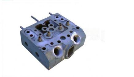
Zylinderkopf 609. Motor ohne Ventile
